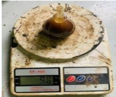
Gambar 3. 18 Mengisi Air Di Piknometer Dan Menimbang
