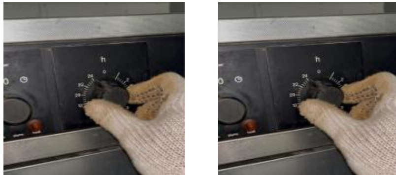
Gambar 3. 14 Suhu Oven 105°C – 110°C Dan Lama Pengerjaan \pm 24 Jam
