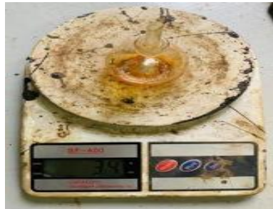
Gambar 3. 15 Timbang Piknometer Kosong
