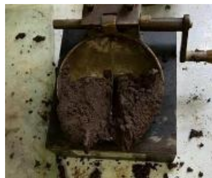
b) Sampel setelah di ketuk
