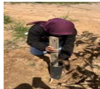
d) pengambilan sampel tanah asli
