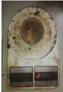
a) Cawan ke 1 (berat tanah basah 40 g)
