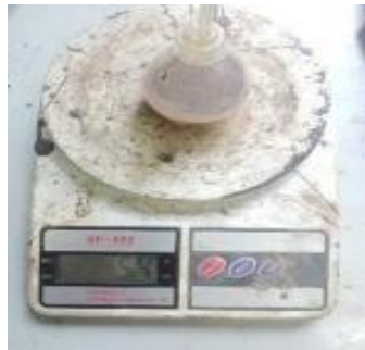
Gambar 3. 16 Menimbang Piknometer Berisi Sampel
