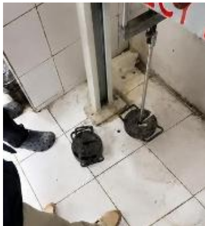
Gambar 3. 30 Memberi beban normal pada pengujian direct shear
