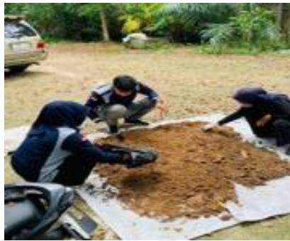
a) penjemuran sampel tanah di bawah sinar matahari
