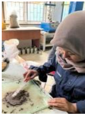
a) Mencampur tanah dan air
