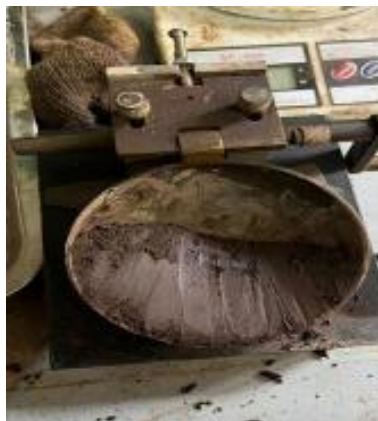
Gambar 3. 21 Tanah Di Masukan Ke Alat Casgrandle
