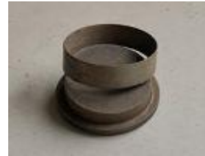
o) Cetakan Benda Uji
