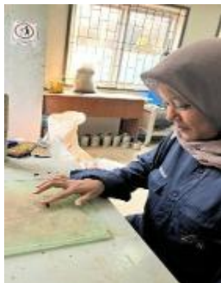
Gambar 3. 25 Memnggulung Sampel Di Atas Pelat Kaca
