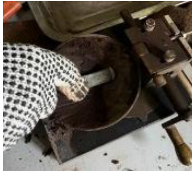
a) Membuat alur menggunakan alat dari set Casagrande
