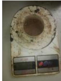
b) Cawan ke 2 (berat tanah basah 48 g)
