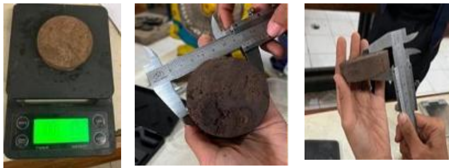
a. Berat Sampel b. Diameter Sampel c. Tinggi Sampel
