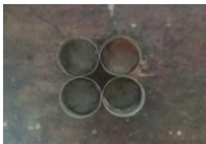
Gambar 3. 11 Memasukan Tanah Basah Ke Dalam Cawan
