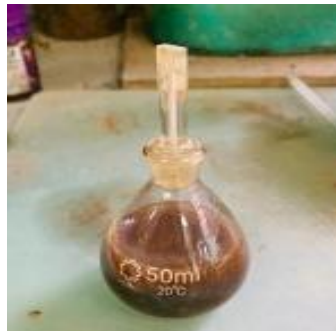
Gambar 3. 17 Mengisi Air Ke Piknometer
