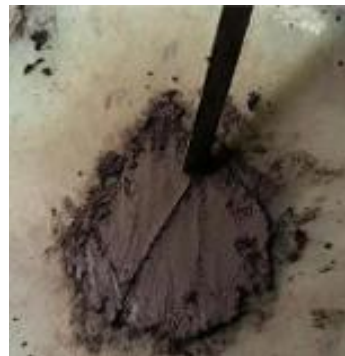
b) Tanah yang sudah melewati pengadukan hingga menjadi homogen
