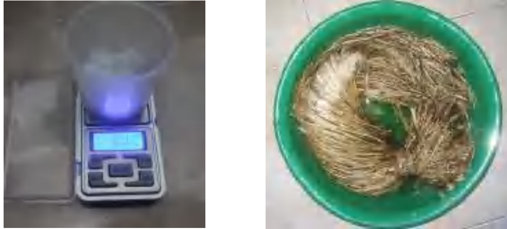
Gambar 3. 2 Perendaman menggunakan NaOH 6%
