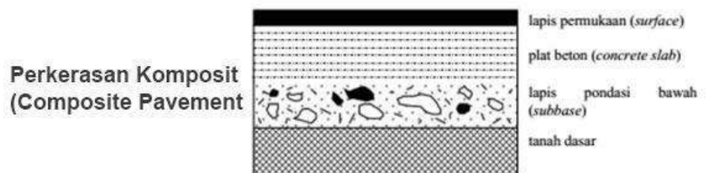
Gambar 2.4 Perkerasan Jalan Komposit
