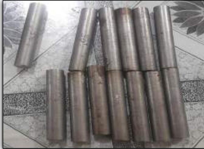
Gambar 3. 4 Spesimen Baja AISI 4140
