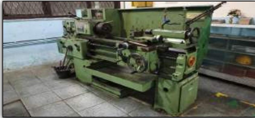
Gambar 3. 1 Mesin Bubut Konvensional ( LAB SMK PGRI 2 PALEMBANG )
