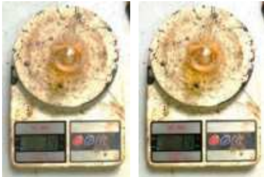
Gambar 3.17 tmbang piknometer kosong
