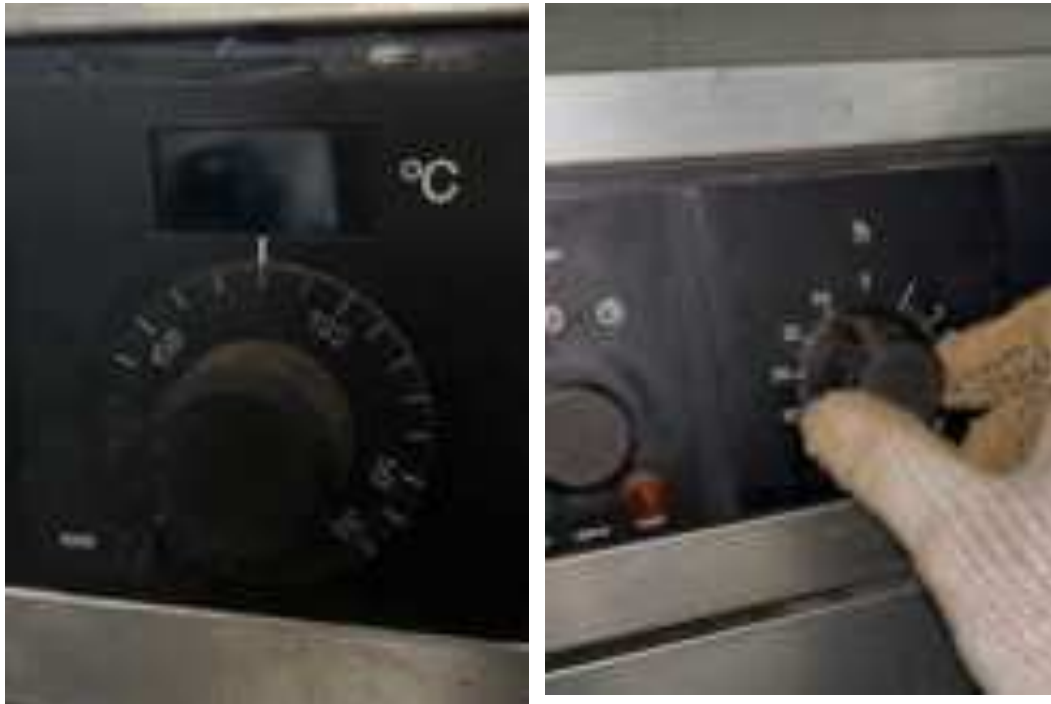
Gambar 3.13 suhu oven 105^{\circ}\text{C} – 110^{\circ}\text{C} dan lama pengerjaan \pm 24 Jam
