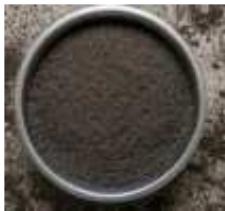
(b) Tanah lempung ekspansif yang telah melewati pengeringan dan lolos analisa saringan
