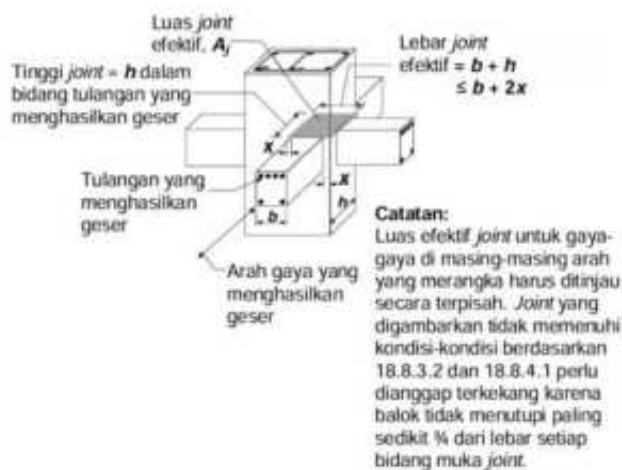
Gambar 2.15 Luas Efektif Hubungan Balok dan Kolom
