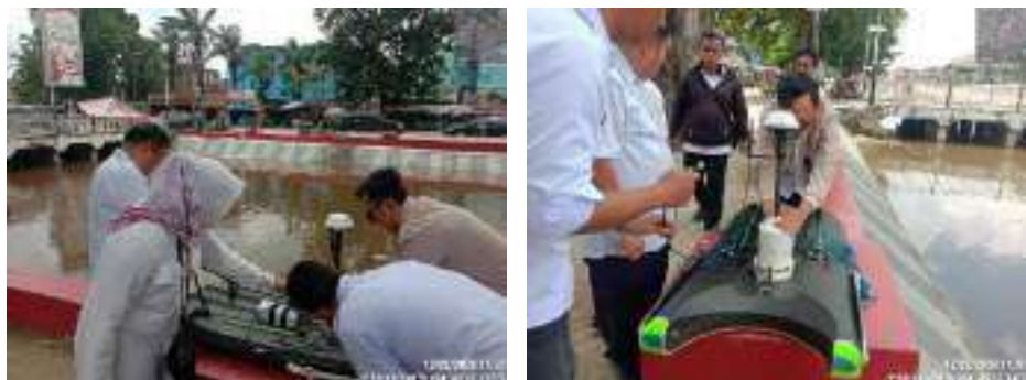
Gambar 4.2 Pemasangan sensor River Surveyor ke Sontek Hydoboard II
