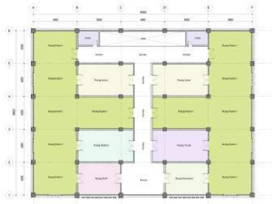
Gambar 4.8 Denah Pembebanan Struktur pada Lantai 6-8
