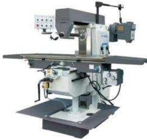
Gambar 2.1 Mesin Frais horizontal
