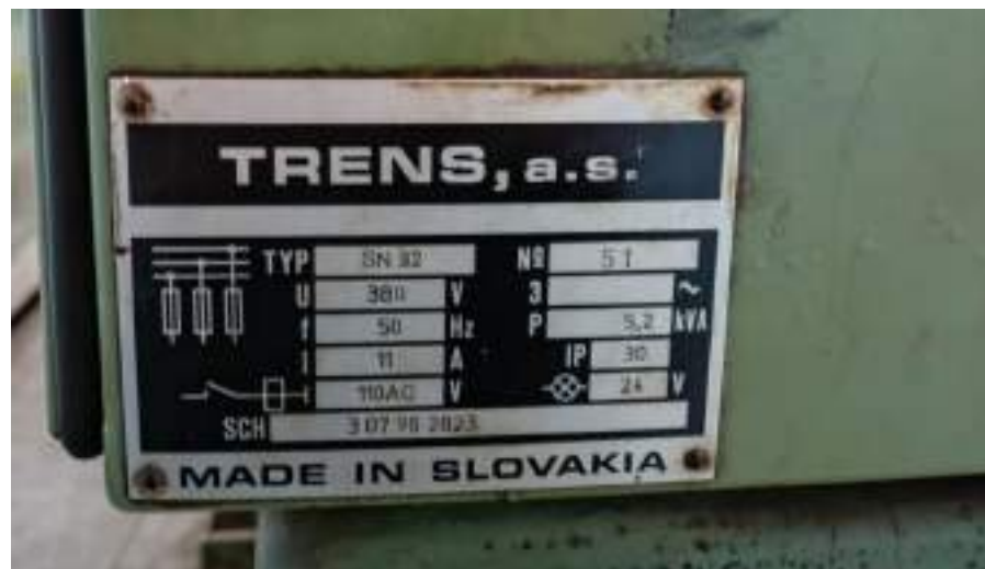
Gambar 3. 2 Spesifikasi Mesin bubut
