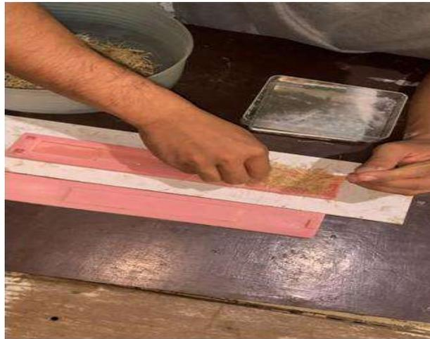
Gambar 3. 19 Peletakan serat tebu
