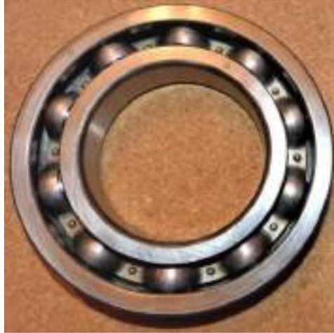
Gambar 3.3 Bearing 6218 90mm x 160mm x 30 mm pada Objek
