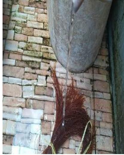
Pencucian serat menggunakan air untuk mengkilangkan sisa NaOH saat perendaman.
