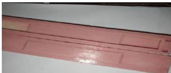
Gambar 3. 13 Cetakan Spesimen Uji Tarik.
